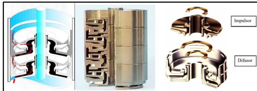
Figura 20. Corte de una etapa de la Bomba Centrífuga, BES. Adaptado de: Fuente: PINTO, Ciro Armando. Bombeo Electrosumergible. UIS, 2012.
