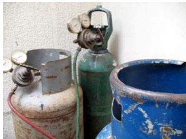
Figura 4. Cilindros de gas y oxígeno.
