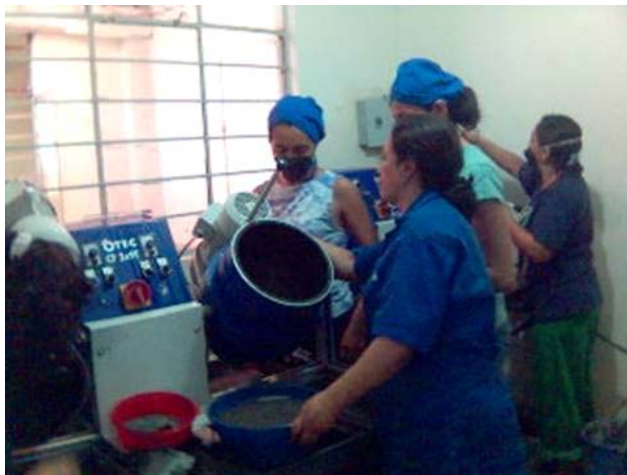
Figura 84. Operarias limpiando las Máquinas Centrífuga de Plato.
