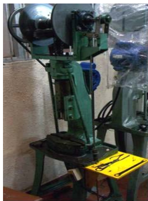
Figura 77. Troqueladora Eléctrica antes del Mantenimiento.
