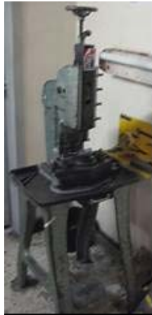
Figura 79. Prensa de corte antes del Mantenimiento
