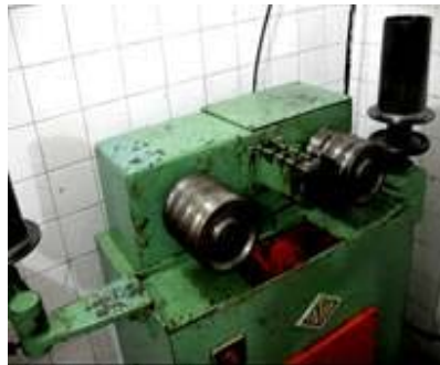
Figura 73. Trefiladora antes del Mantenimiento.
