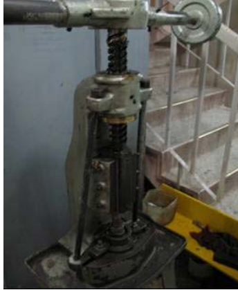
Figura 75. Troqueladora antes del mantenimiento.
