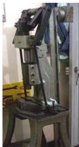
Figura 81. Prensa Progresiva antes del Mantenimiento.
