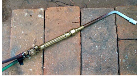
Figura 3. Soplete con Conexión a gas y oxígeno.
