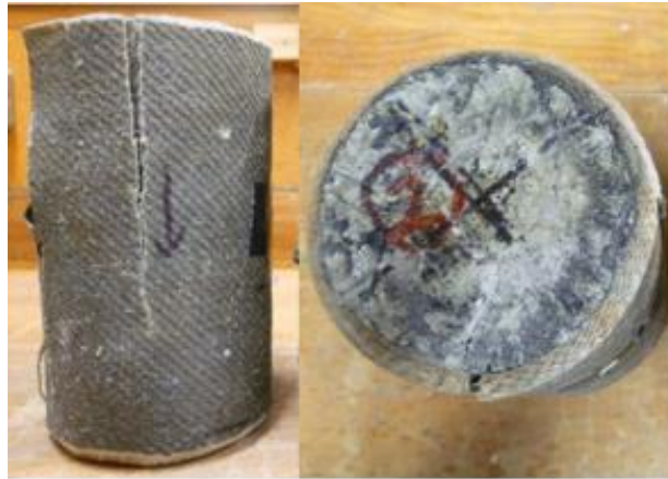
Figura 15. Cilindro de concreto reforzado externamente de fibras de lino.
