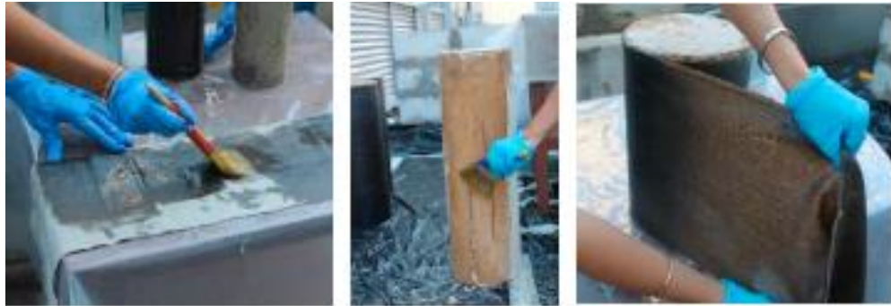
Figura 16. Preparación del espécimen reforzado con tejido de cáñamo.
