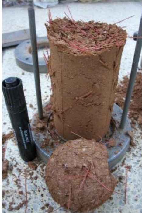
Figura 2. Suelo arcilloso con fibras PET. Adaptado de Suelos arcillosos reforzados con materiales de plástico reciclado PET, Disponible en: https://repository.eia.edu.co/bitstream/11190/265/1/CIVI0402.pdf
