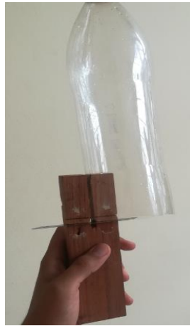
Figura 12. Forma en la que se empieza a transformar el PET en cinta de 0.5 cm de ancho.
