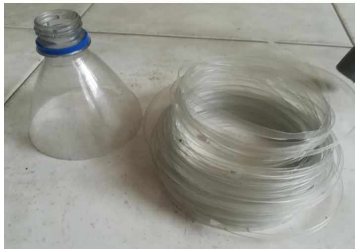
Figura 13. Resultado del proceso de transformación de envase a cinta.
