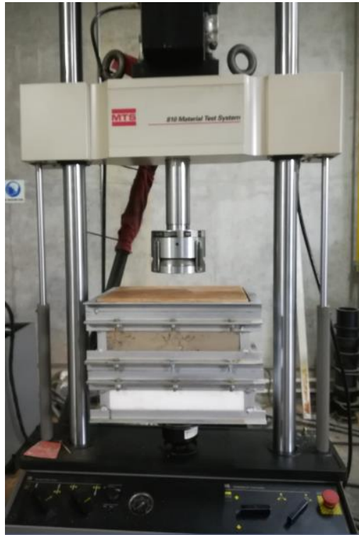
Figura 9. Montaje en la maquina MTS-810 de la estructura para ensayos.
