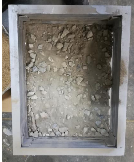
Figura 7. Capa de suelo granular en el módulo
