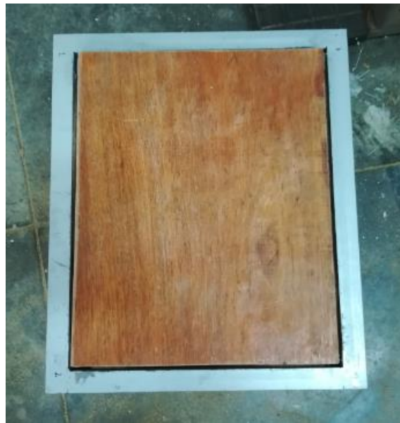
Figura 8. Aglomerado de madera en la parte superior de la estructura.
