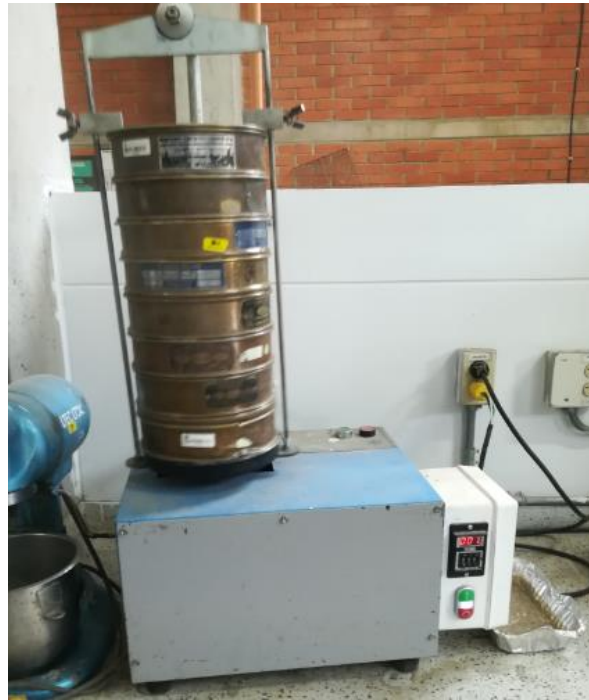
Figura 15. Tamizado del suelo granular.
