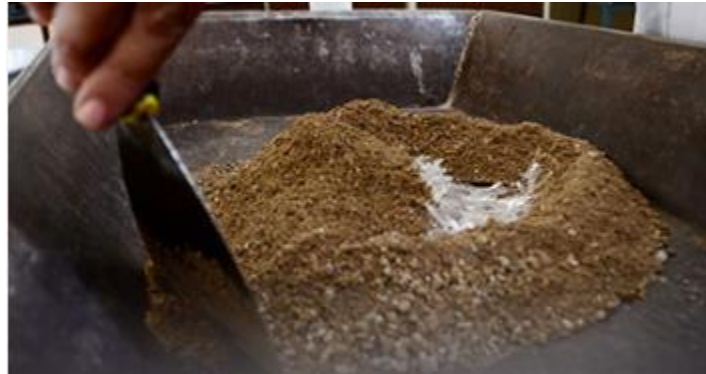
Figura 1. Mezcla de mortero con fibras de PET. Adaptado de Fibras de PET para la construcción, Disponible en:
