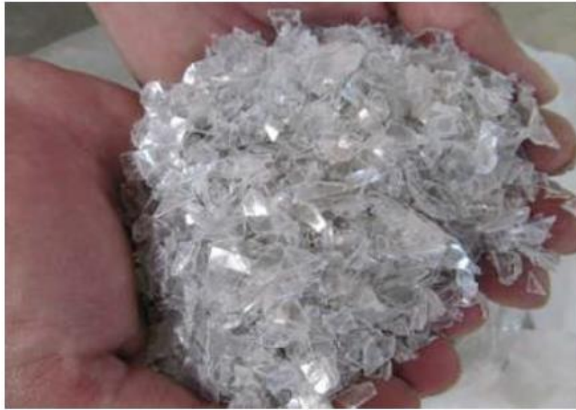
Figura 3. Escamas de PET procesadas. Adaptada de Cortes, Eduardo; Arciniegas, Luis; Salinas, Yamid. (2016). Influencia de la inclusión del reciclaje de botellas plásticas como uno de los componentes en la conformación de materiales granulares pétreos para pavimentos. En: Revista Ingenieros Militares. Vol 11. p. 60.
