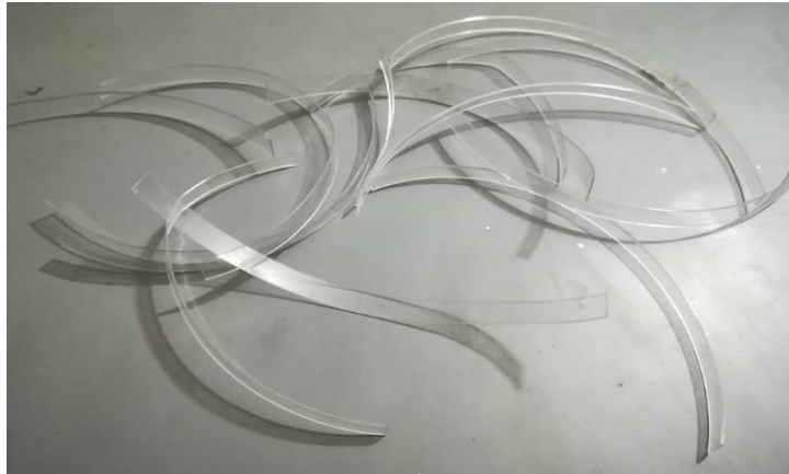
Figura 14. Fibras obtenidas a partir de envases recolectados.
