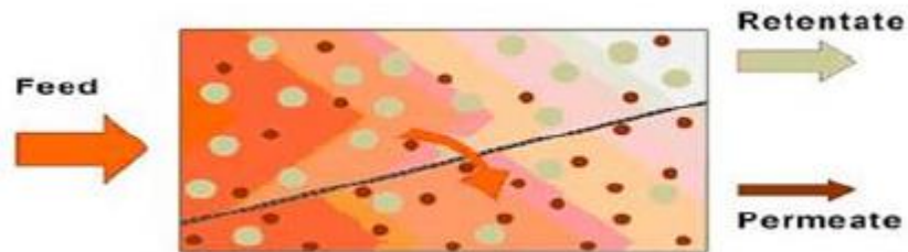
Figura 5. Modelo esquemático del funcionamiento de la membrana
