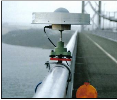
Figura 4. Antena choke-ring Leica localizada sobre la baranda del puente.
