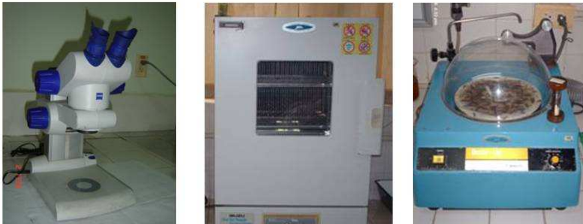
Figura 4. a) Lupa binocular (Marca Stemi DV4. Zeiss) ubicada en el Laboratorio de Arcillas de la Escuela de Geología UIS, b) Mufla Marca Isuzu serial 40254206, y c) Pulidora Marca Doctor / Lap Maruto, ubicadas en el Laboratorio de mineralogía del INGEOMINAS sede Santiago de Calí.
