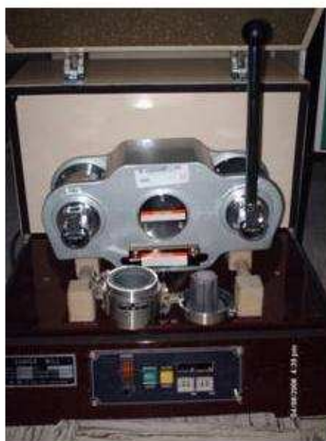
Figura 7. Molino de rodillo de tungsteno (Sample Mill Model TI – 100). Laboratorio de Trituración - INGEOMINAS, Sede Santiago de Cali.
