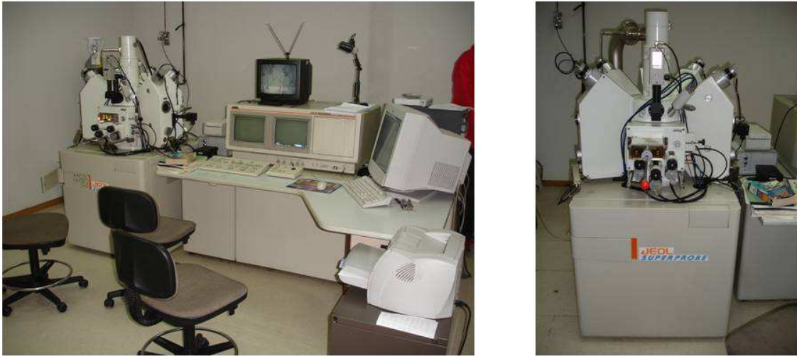
Figura 9. Microsonda marca JEOL, modelo JXA 8900 M. Laboratorio de Servicio de microscopía “Luis Bru” de la Universidad Complutense de Madrid (España).
