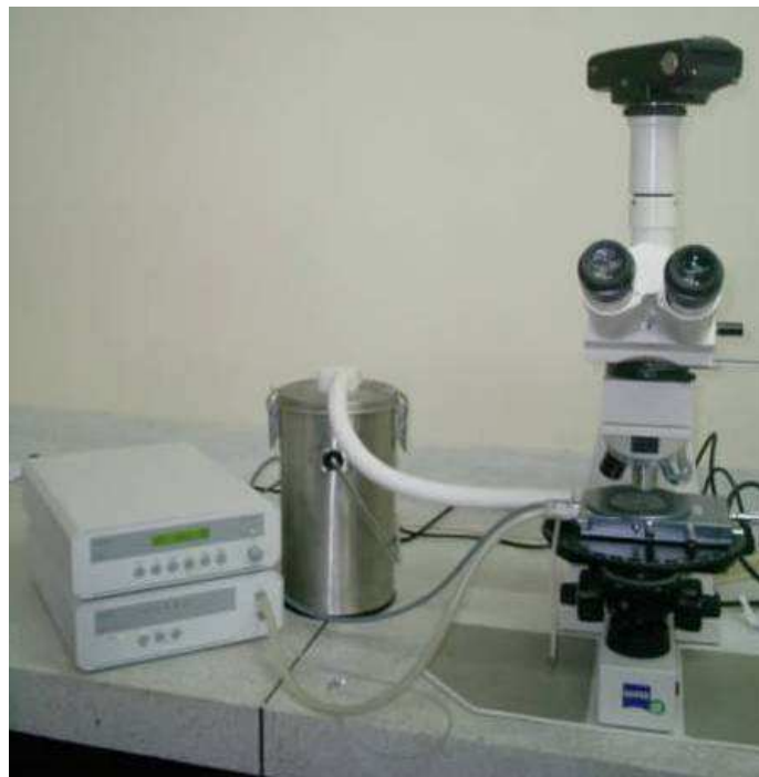
Figura 8. Platina de enfriamiento – calentamiento, tipo THMS 600 marca LINKAM. Laboratorio de Microtermometría de IF de la Escuela de Geología, UIS - Sede Guatiguará.
