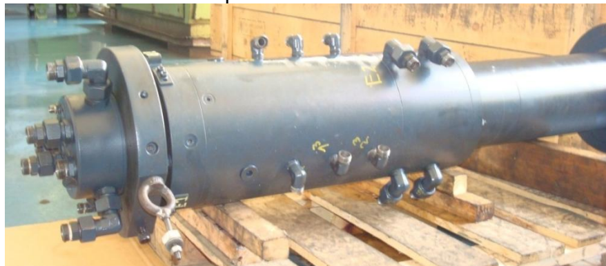
Figura 226. Árbol Distribuidor en posición Horizontal.
