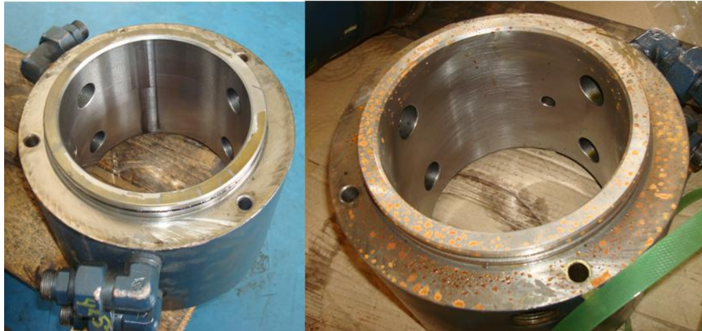
Figura 121. Problemas encontrados en las camisas del árbol
