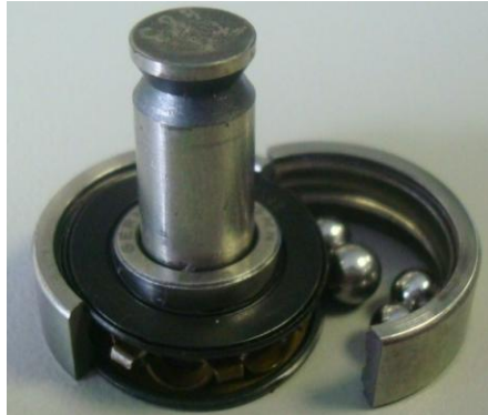
Figura 126. Rodamientos del mecanismo de balancines rotos.
