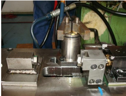
Figura 172. Movimiento: Indexación de las Copas.
