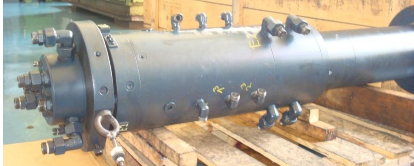
Figura 118. Árbol distribuidor en posición Horizontal
