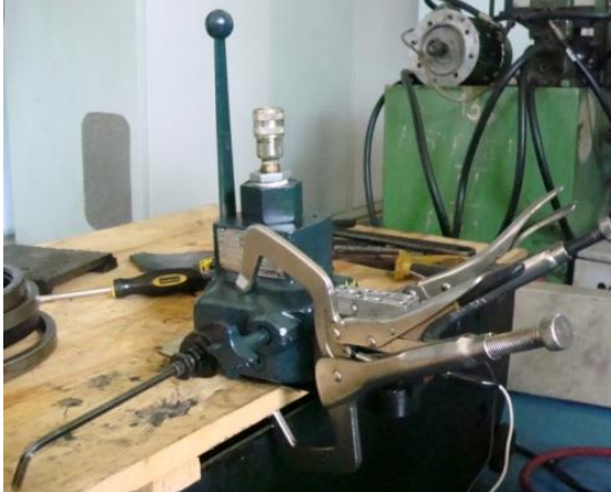
Figura 83. Prueba del bloque de válvulas del Acumulador.
