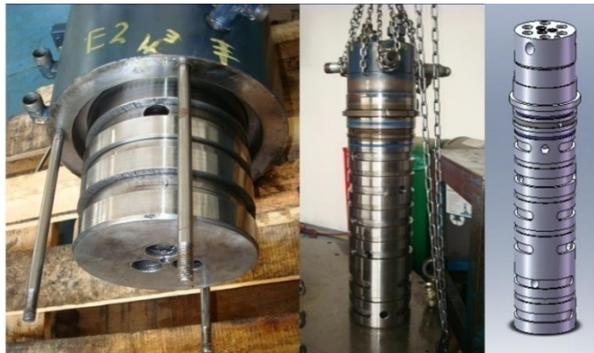
Figura 117. Desarme del árbol distribuidor.
