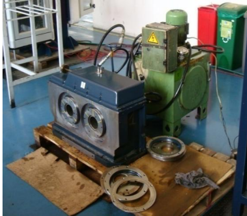
Figura 109. Banco Hidráulico para Pruebas en los módulos de Trabajo.
