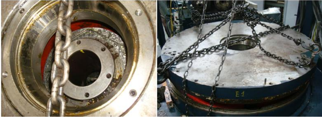
Figura 122. Desmonte de la Mesa de Indexación.
