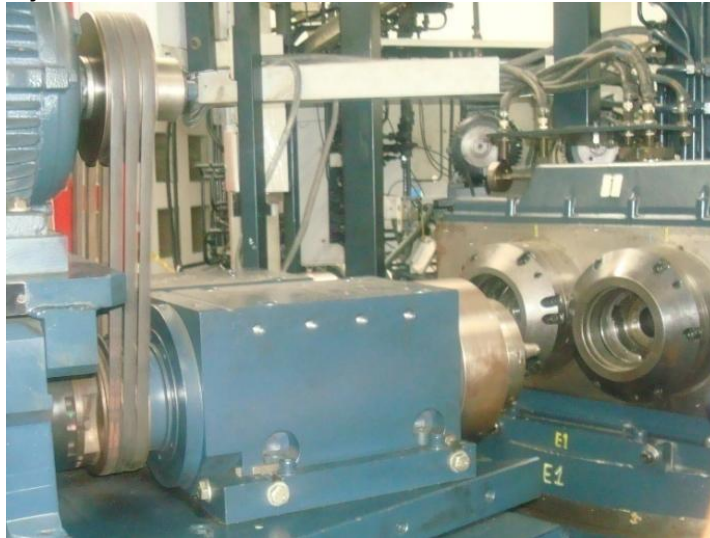
Figura 129. Montaje de los husillos
