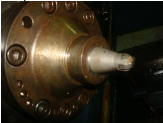
Figura 239. Prueba Anclaje de la Hta.
