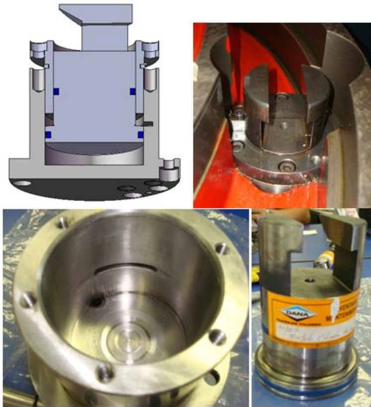
Figura 127. Cilindros de anclaje de la mesa de indexación
