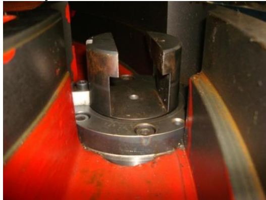
Figura 59. Cilindros de Anclaje de la Mesa de Indexación
