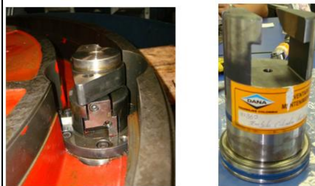
Figura 160. Cilindros de Anclaje de la Mesa de Indexación.
