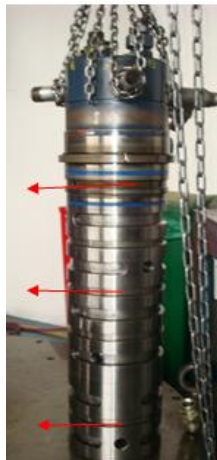
Figura 189. Líneas de Aire árbol Distribuidor.
