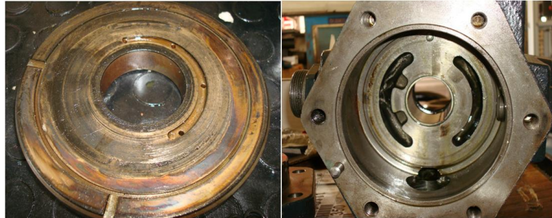
Figura 78. Estado de la Bomba Hidráulica.
