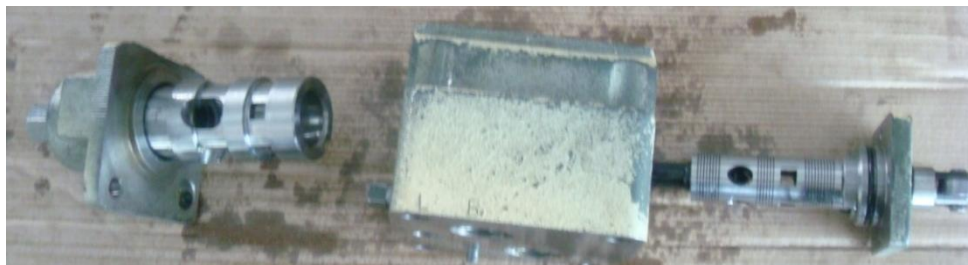
Figura 97. Desarme de la válvula desaceleradora.
