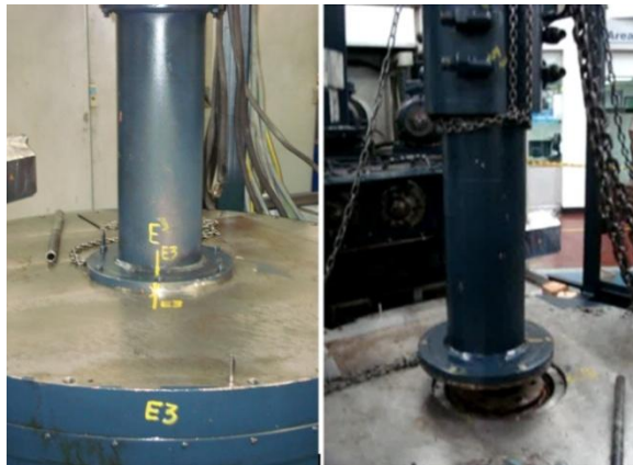
Figura 116. Levantamiento árbol Distribuidor.
