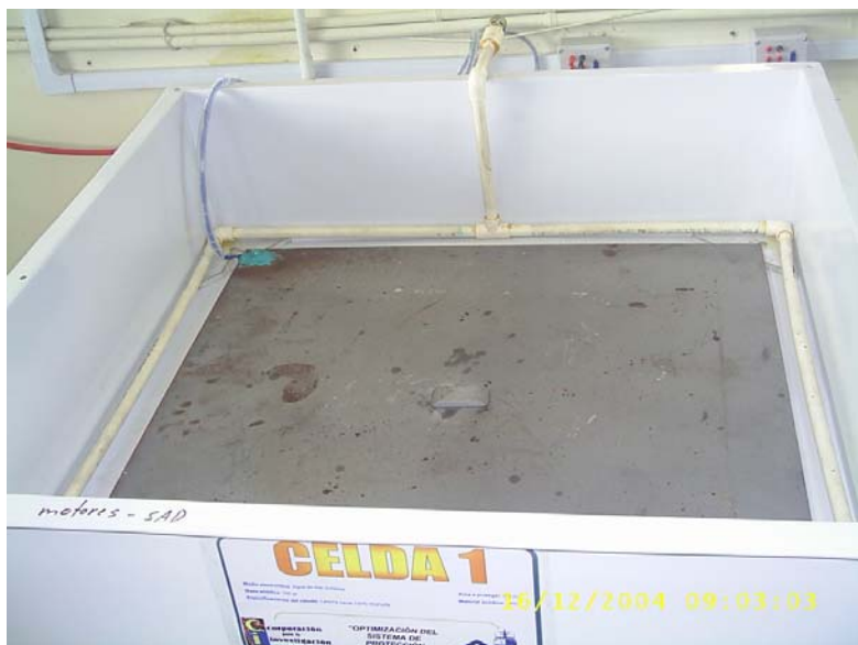
Fotografía 2. Ánodo de zinc de 100gr sobre la lámina de acero naval.
