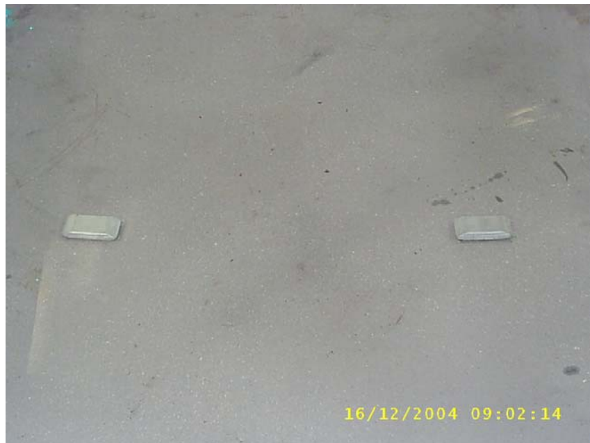
Fotografía 4. Separación de los ánodos de zinc de 50gr a una distancia de 6X.
