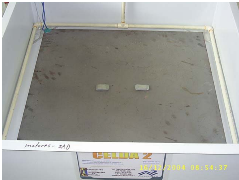
Fotografía 3. Separación de los ánodos de zinc de 50gr a una distancia de 2X.
