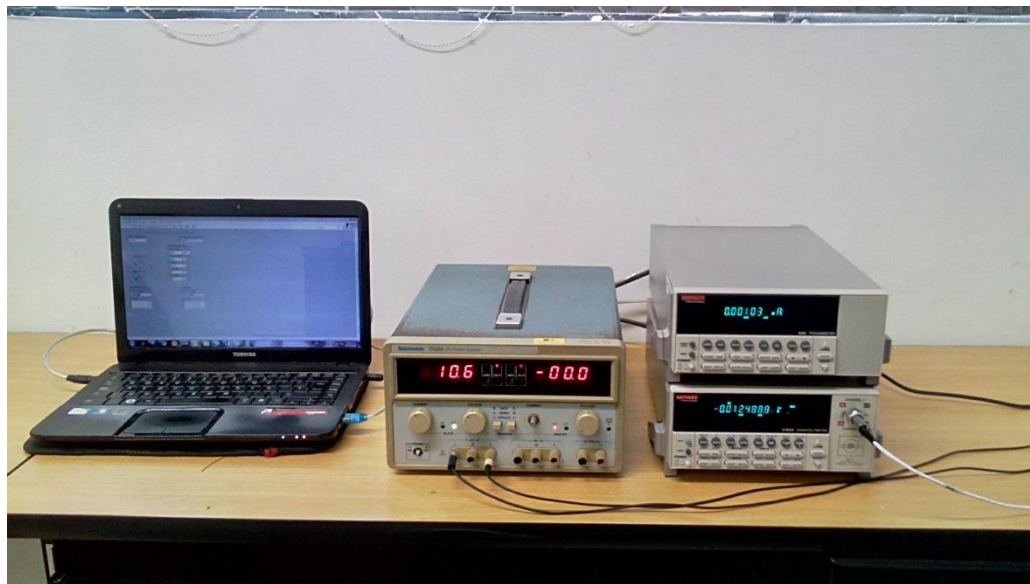
Figura 3.5. Montaje de equipos, utilizado en modelo de medición Van Der Pauw.
