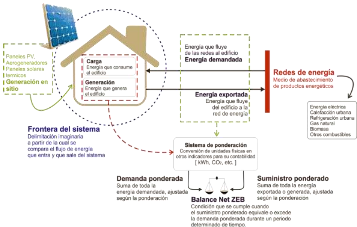
Figura 2. Esquema de un sistema con generación en sitio y conectado a la red.
