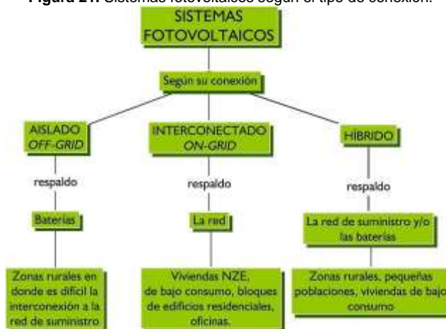
Figura 21. Sistemas fotovoltaicos según el tipo de conexión.
