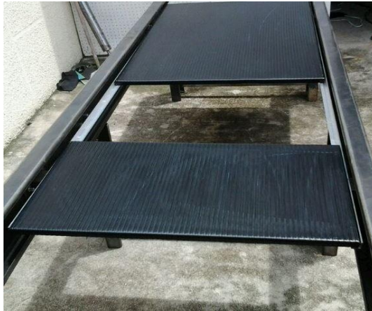
Figura 36. Placa soporte de la banda metálica.
