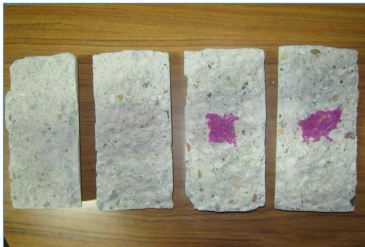
**Figura 29. Profundidades de carbonatación para el 0, 10, 15 y 20% de sustitución**
