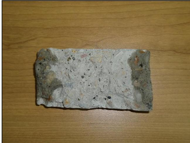
Figura 20. Profundidad de penetración, ensayo de permeabilidad
