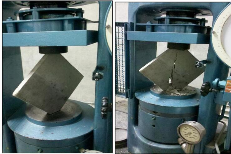
**Figura 16. Ensayo a compresión diagonal**
