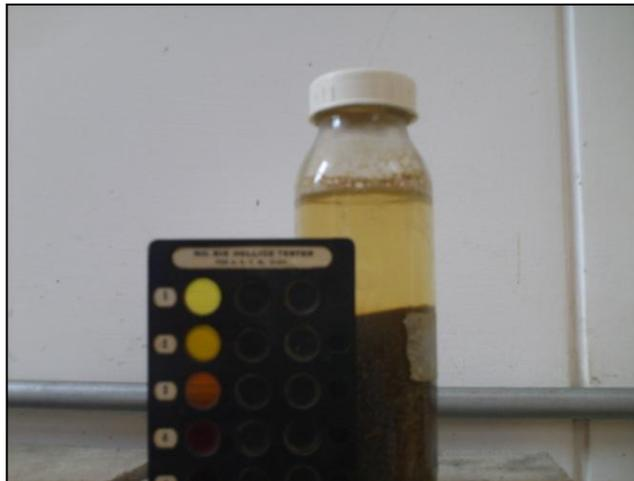
**Figura 17. Ensayo de colorimetría para el agregado fino**
