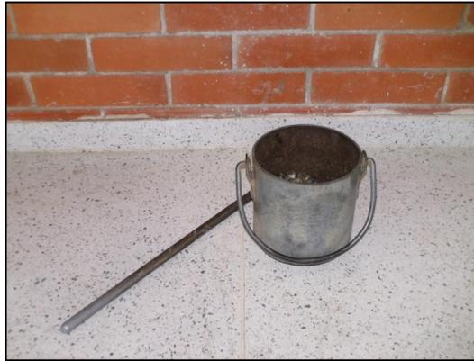
**Figura 9. Elementos de laboratorio para determinar la masa unitaria del agregado grueso y fino (56)**
