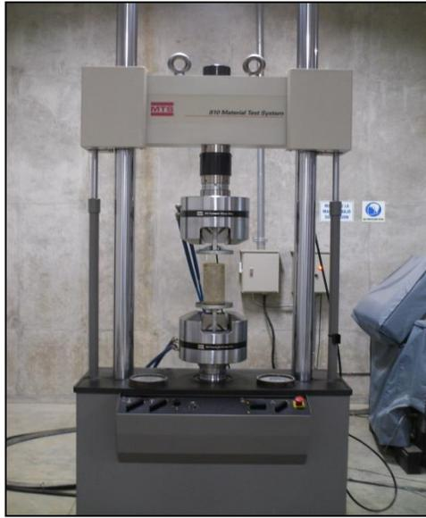
**Figura 12. Ensayo de probetas a compresión**
