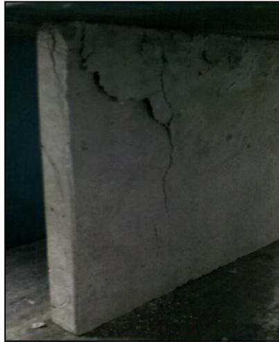
**Figura 15. Ensayo a compresión longitudinalmente**
