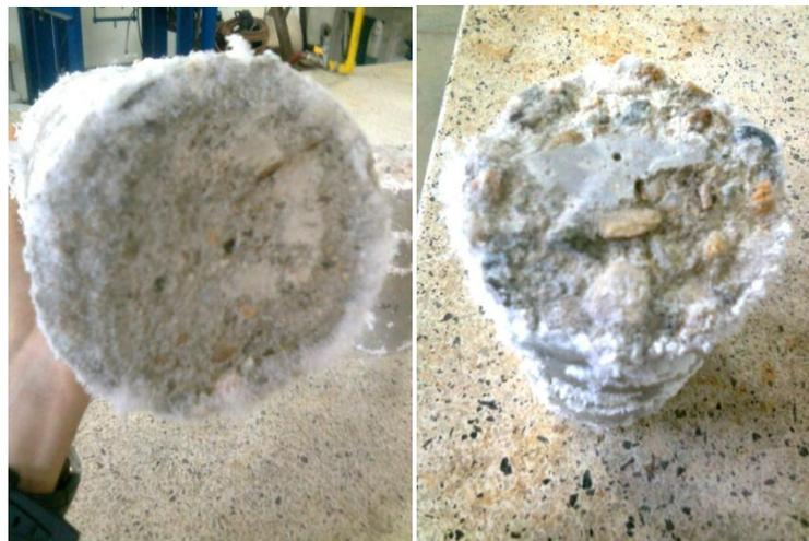
**Figura 27. Aspecto de las probetas durante el ensayo de sulfatación acelerada**
