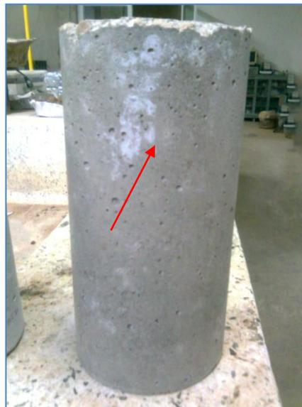
**Figura 24. Eflorescencias presentes en las probetas, ensayo de reacción álcali árido**
