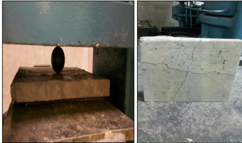
**Figura 14. Ensayo a flexión en el plano débil**
