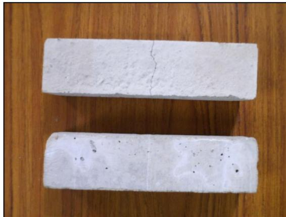
**Figura 11. . Falla por carga a flexión**
