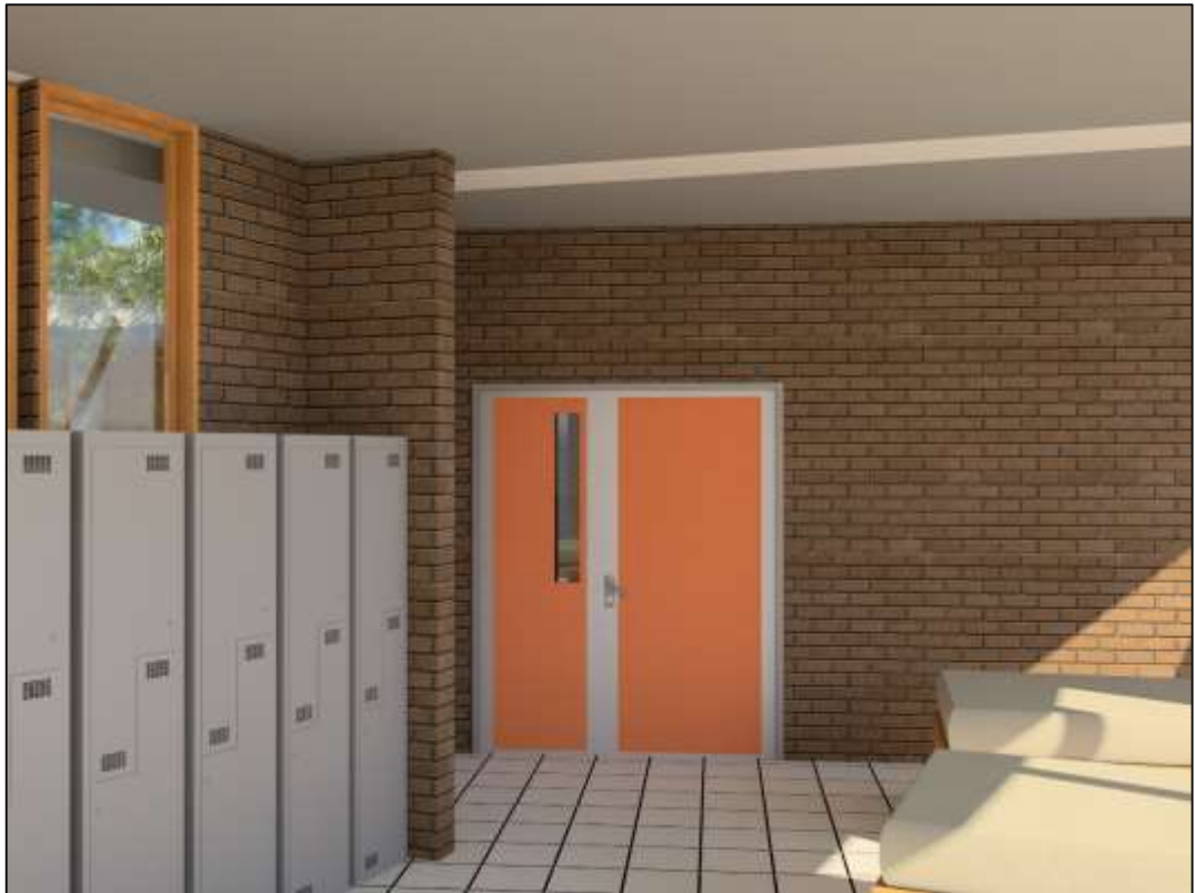
Figura 7. Familia de puerta doble hoja con cristal creada para el edificio de Tratamientos del CRF.
