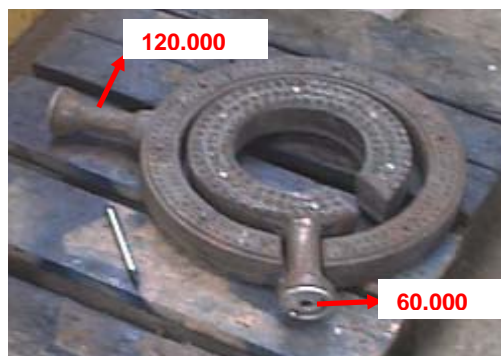
Figura 17. Disposición de los quemadores atmosféricos radiales
