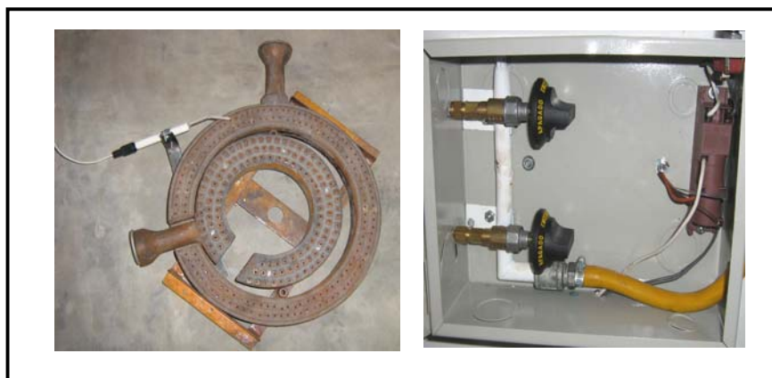
Figura 20. Elementos del sistema de encendido eléctrico
