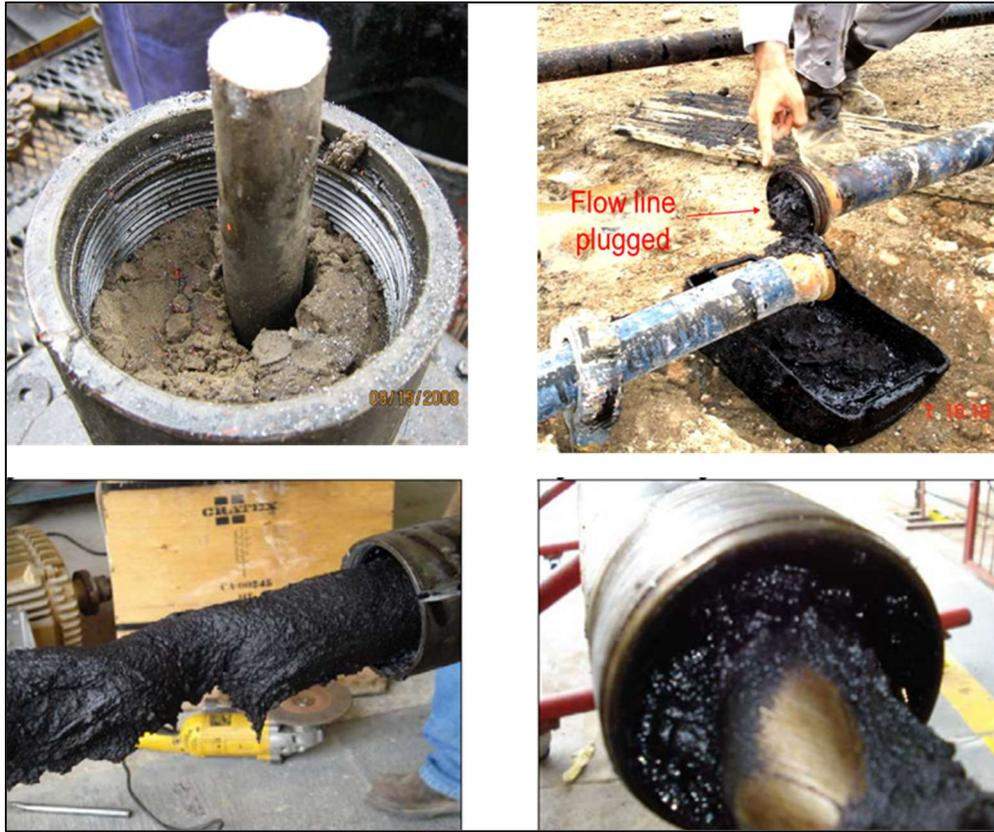
Figura 11. Fotografías con evidencia de la arena producida en el campo.
