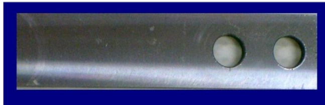
Imagen 1. Cupón en acero AISI SAE 1020.
