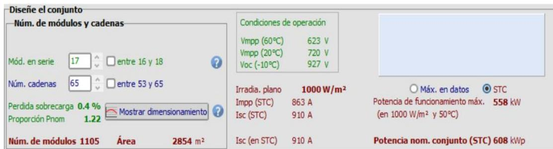
El sistema fotovoltaico cuenta con 17 módulos en serie y 65 en cadena, siendo un total de 1105 módulos solares, los cuales quedaran distribuidos como muestra la figura 32.
