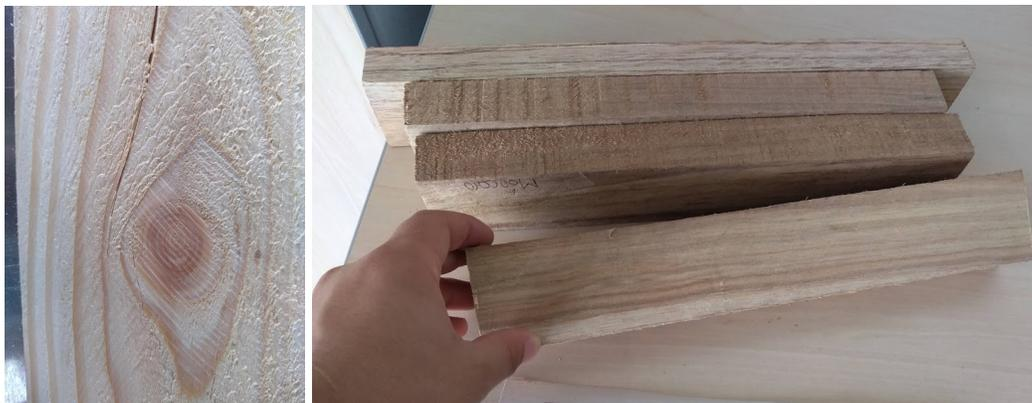
*Nota:* Bloques de madera utilizados como muestra. A la izquierda, una muestra de pino y, a la derecha, algunas muestras de múncooro.
