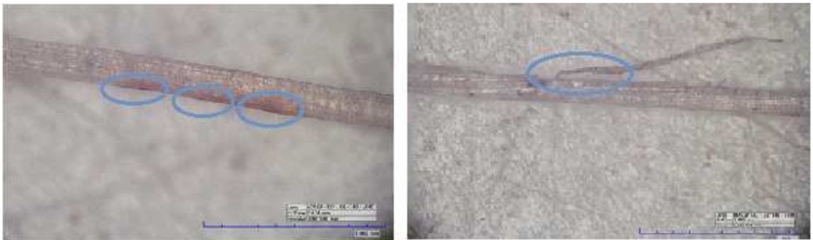
Figura 15. Impurezas y desgarre de microfibrillas en fibras de fique.
