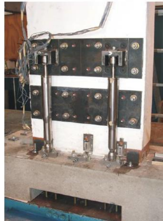
Figura 10. Muro oscilante con amortiguadores suplementarios (TCY).
