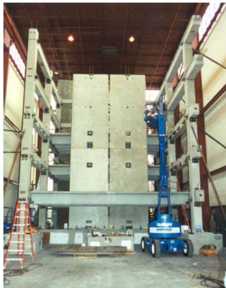
Figura 6. Sistema de Muros Prefabricados Articulado “Edificio PRESSS”.
