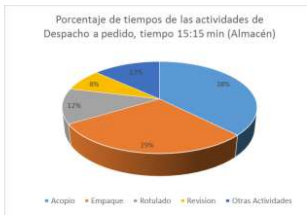
Figura 62. Estudio final proceso de alistamiento en bodega.
