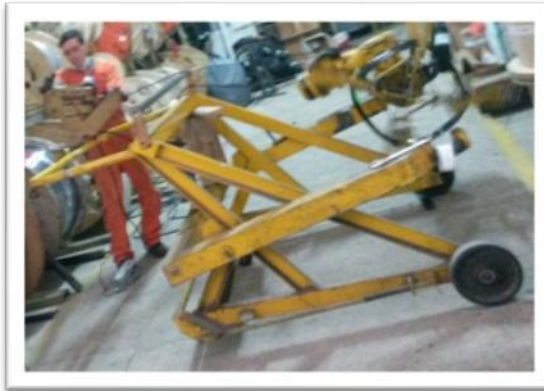
Figura 22. Extracción de cable por medio de la bobinadora
