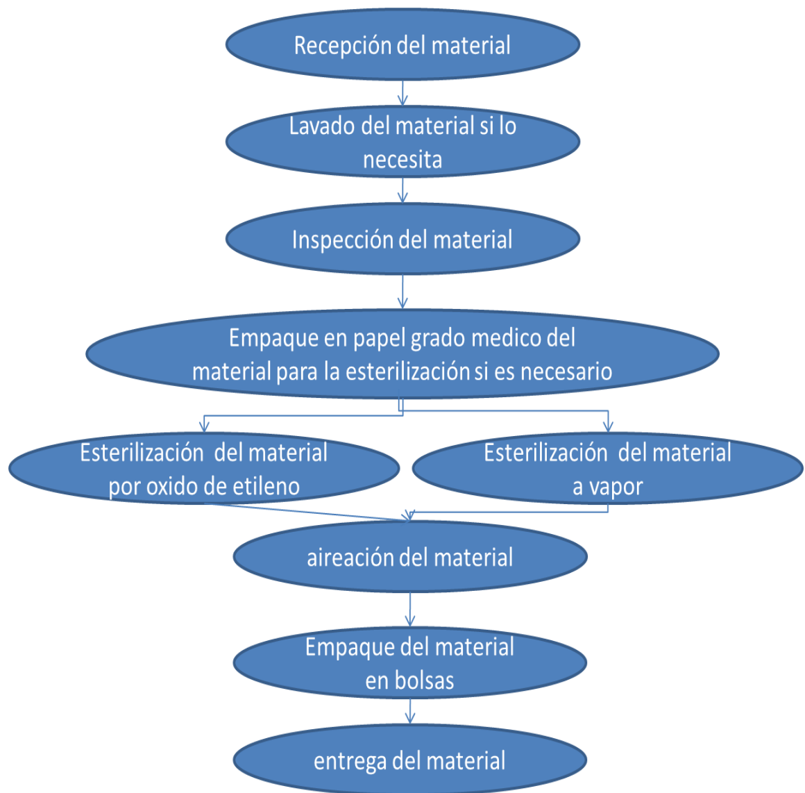
Figura 15. Diagrama de bloque. Descripción de las actividades que se realizan en la central de esterilización
