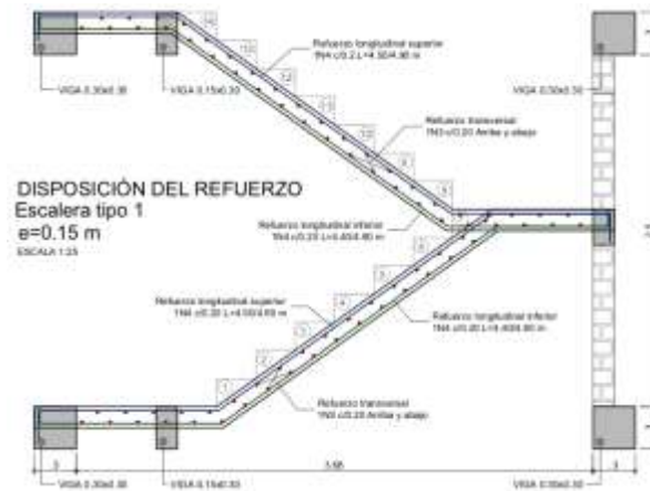
Figura 4. Disposición de refuerzo de escalera.
