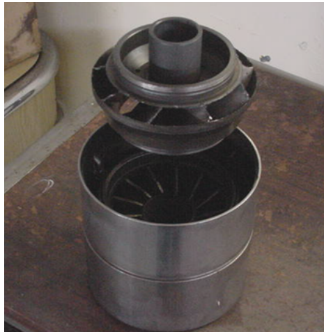
Figura 30. Etapa de una bomba Bombeo Electrosumergible
