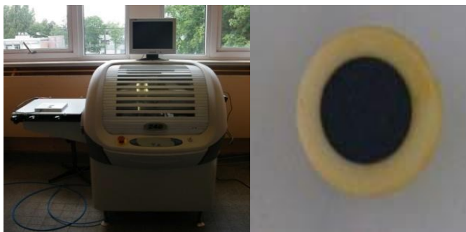
Figura 4. Equipo de serigrafía y deposición de tinta sobre un electrolito de GDC.
