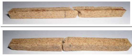
Figura 32. Probetas después del ensayo de impacto. Arriba muestra C, abajo muestra F
