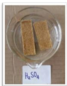
Figura 24. Aglomerados C (izq.) y F (der.) en \text{H}_2\text{SO}_4
