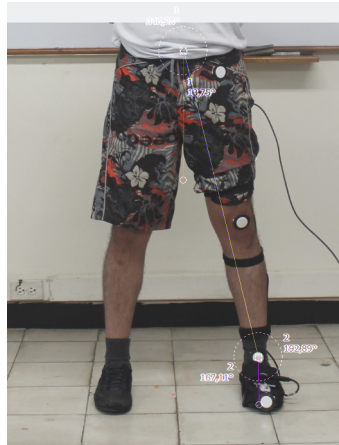
Figura 6.10: Movimiento de la extremidad inferior en el plano frontal para la segunda prueba.
