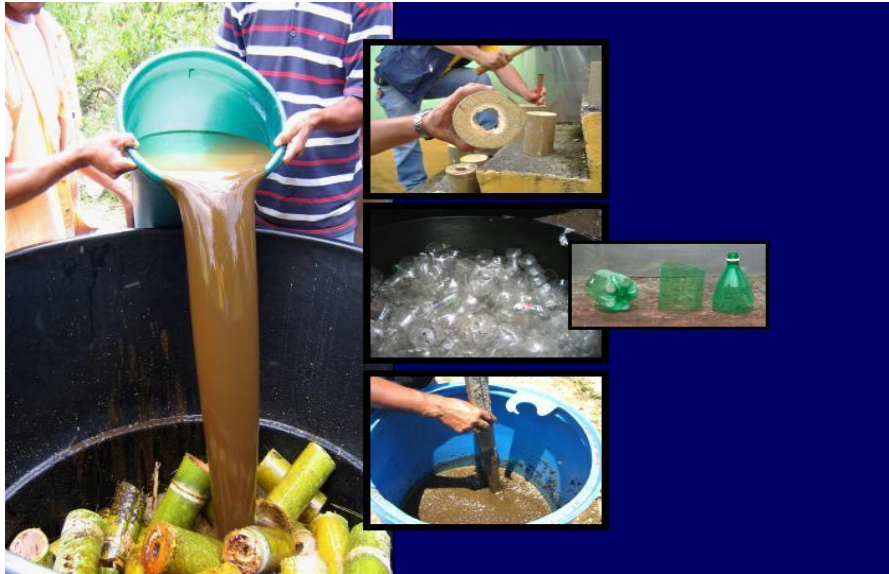
Figura 21. Preparación de un Tanque Reactor Metano génico-cenicafe.
