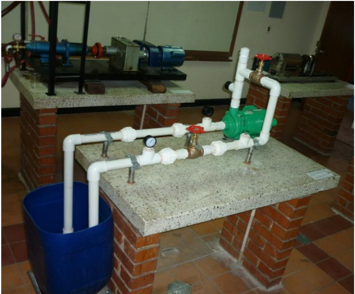
Figura 13. Banco de pruebas para el estudio de cavitación mediante análisis de vibraciones mecánicas instalado en el laboratorio
