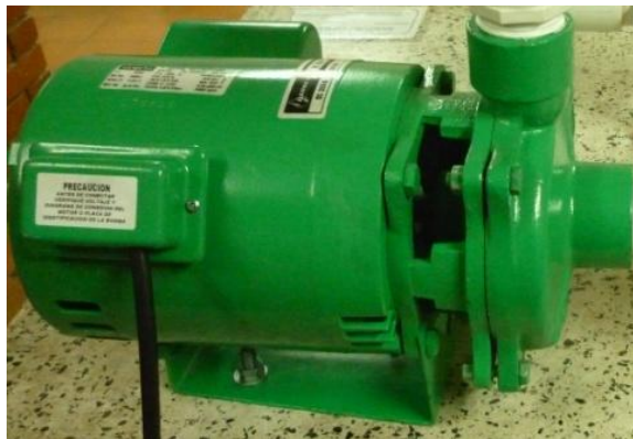
Figura 8. Bomba centrífuga seleccionada para el banco de pruebas
