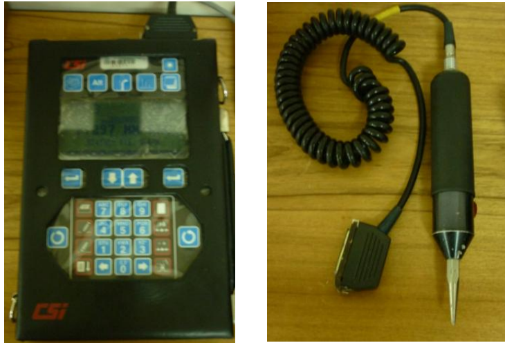
Figura 22. Analizador de vibraciones y acelerómetro usados en pruebas
