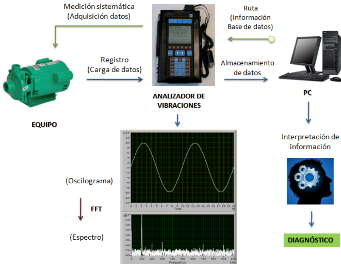
Figura 21. Procedimiento de análisis de vibraciones llevado a cabo en banco de pruebas
