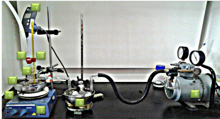
Figura 3. Montaje utilizado para la polimerización de glicerol. 1. Termocupla; 2. Entrada de nitrógeno; 3. Termómetro; 4. Entrada de catalizador; 5. Reactor; 6. Baño de aceite mineral; 7. Plancha de calentamiento; 8. Condensador; 9. Bomba.
