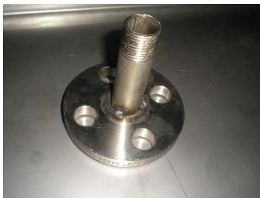
Figura 8. Brida y niple punteado con soldadura
