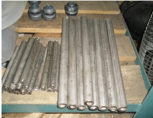
Figura 3. Tramos de tuberías a soldar con las bridas
