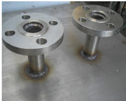
Figura 10. Brida soldado al tanque
