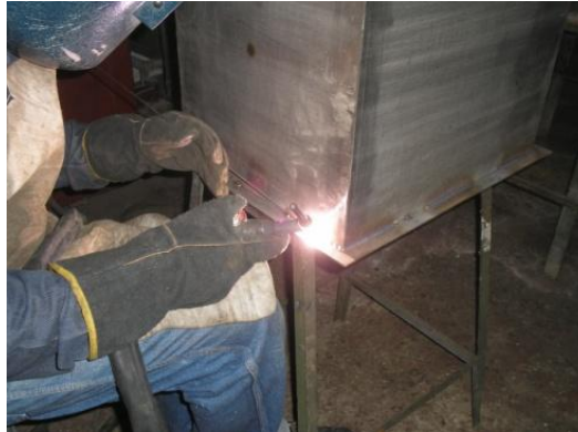
Figura 9. Soldadura del tanque
