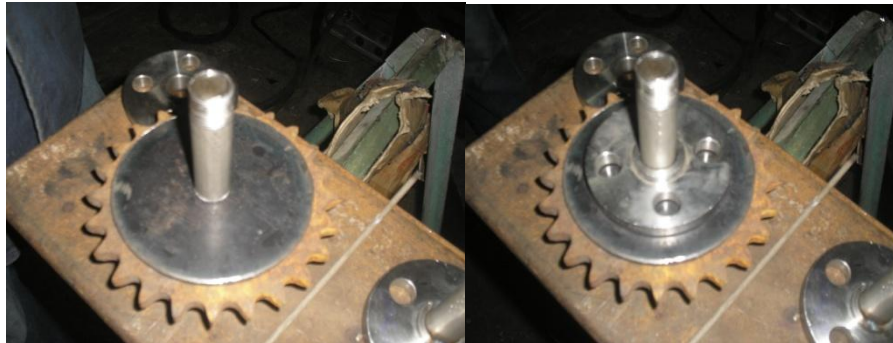
Figura 4. Matriz para soldad la brida y el niple del banco de pruebas
