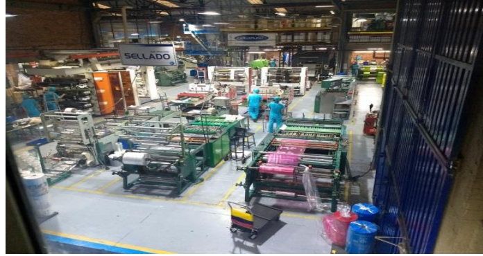
Figura 25. Planta de producción con demarcación de áreas
