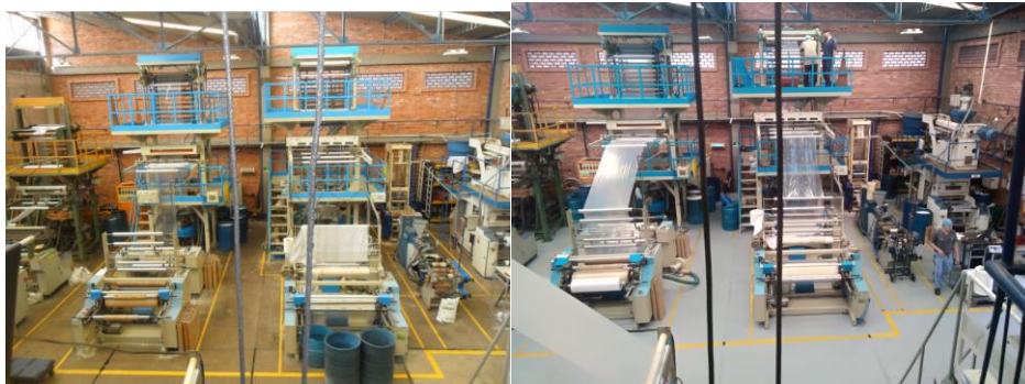
Figura 10. Planta de producción antes y después de aplicar pintura epoxica
