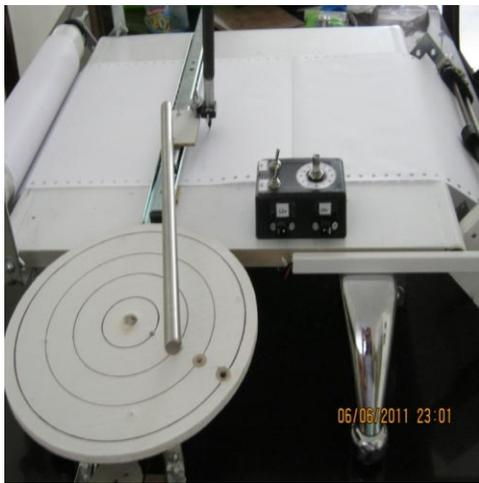
El disco que hace parte del dispositivo está fraccionado en círculos de diferentes radios:  $1/4$ ,  $2/4$ ,  $3/4$  y  $4/4$ ; Cada uno de estos radios me representa el valor del parámetro (A) en la ecuación que es la amplitud; dependiendo de la posición en que se ubique la partícula, se refleja un comportamiento de variación en la altura de la gráfica.
