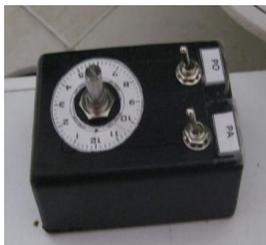
Para la enseñanza de funciones de la forma  $y = \operatorname{sen}(nx)$  e  $y = \operatorname{cos}(nx)$ , se implementó en el equipo graficador un potenciómetro, con el fin de regular la velocidad de rotación de la partícula y permitirle al estudiante la observación, y el
