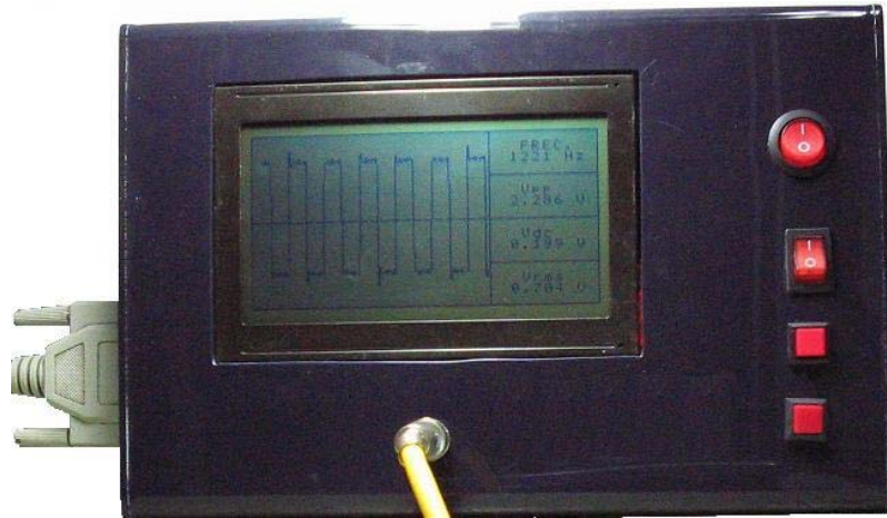
Figura 64. Visualización de la forma de onda de una señal cuadrada a 1,2kHz.
