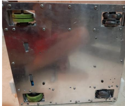
Figura 16. Prototipo de la base usando las ruedas omnidireccionales.
