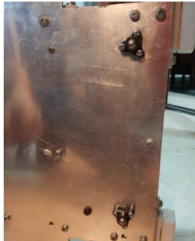
Figura 15. Prototipo de la base con apoyo esféricas sin suspensión.
