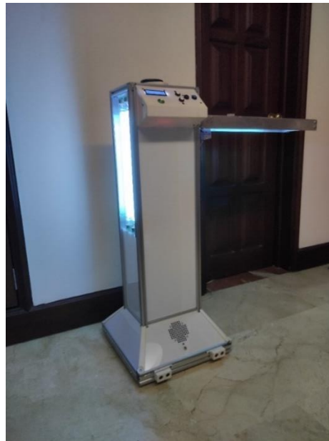
Figura 10. Foto del prototipo con los bombillos UVc encendidos.
