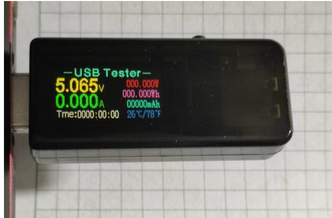
Figura 27. Tester USB para la medición de carga.
