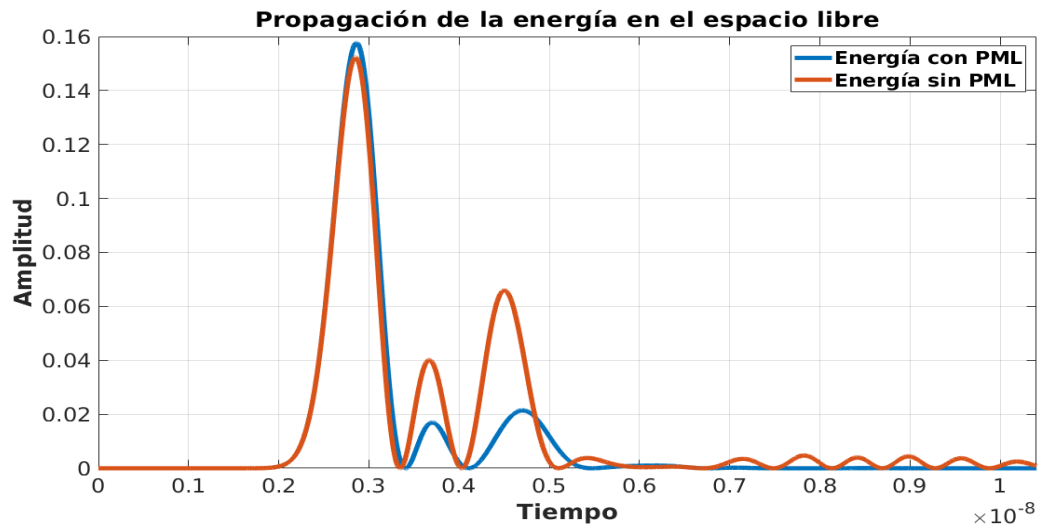
Figura 8. Prueba realizada para comparar la energía medida por un receptor cuando se tiene condiciones de frontera y cuando no se usan.
