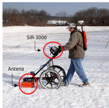
Figura 9. Sistema GPR para la prospección del subsuelo usando una antena de 400 [MHz] de la empresa GSSI.
