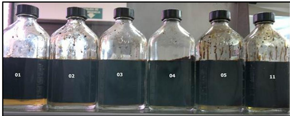
Figura 40. Prueba de la botella. Con espuma YL10.
