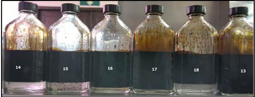
Figura 36. Prueba de la botella. Crudo sin espuma.
