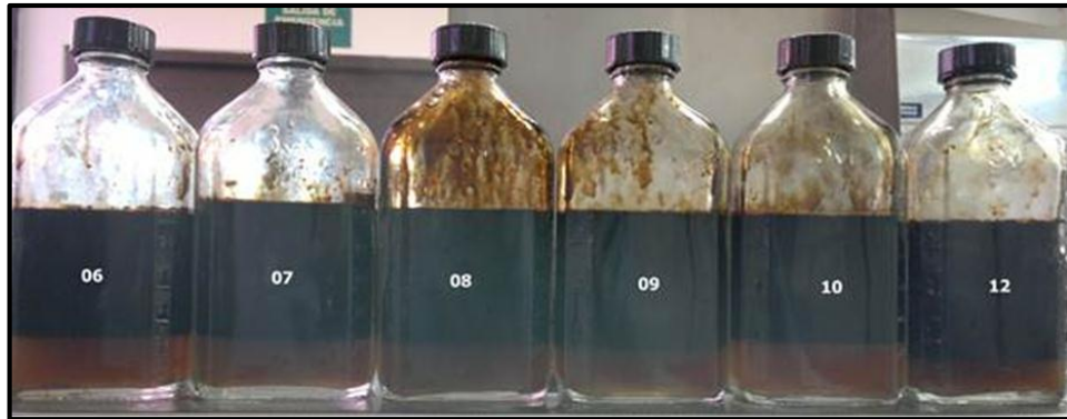
Figura 38. Prueba de la botella. Con espuma HY4.
