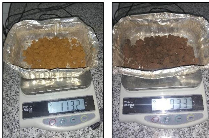
Figura 4. Muestra de suelo húmedo y seco, respectivamente.
