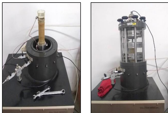
Figura 6. Montaje de la probeta en el equipo triaxial dinámico.
