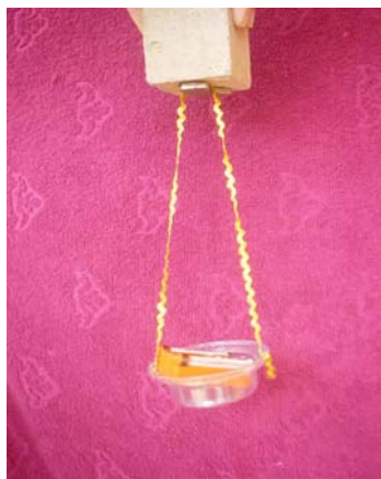
Figura 8. Montaje ensayo de adherencia
