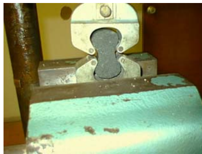
Figura 11. Montaje ensayo de tracción
