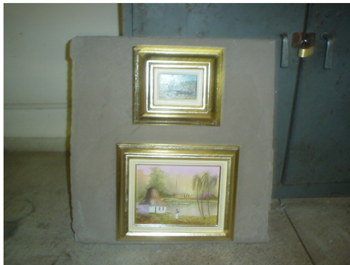
Figura 50. Pared con recubrimiento de mortero magnético R30/70 decorada mediante la utilización de imanes de neodimio (relación área imán respecto al cuadro: 1/100)
