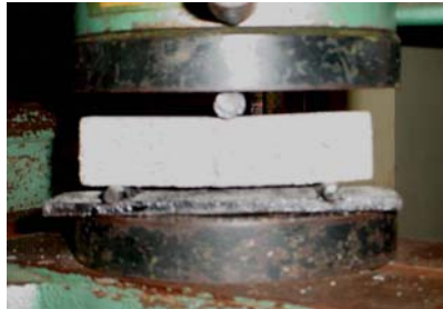
Figura 10. Montaje ensayo de flexión
