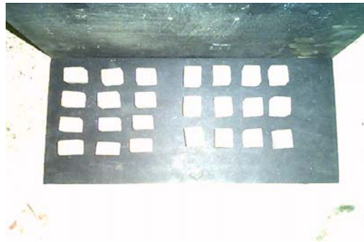
Figura 14. Probetas utilizadas para los ensayos de permeabilidad y porosidad
