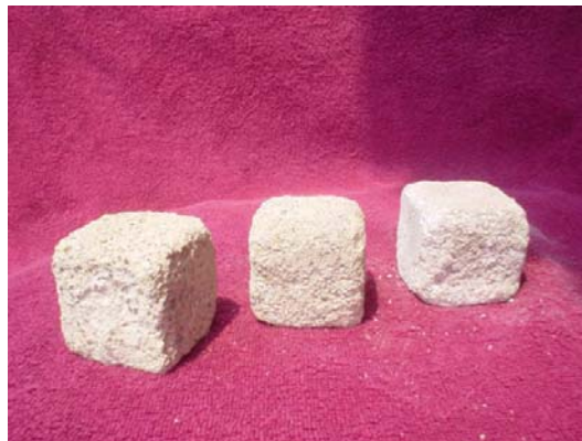
Figura 44. Probetas con agregado magnético sometidas a desgaste por sulfatos
