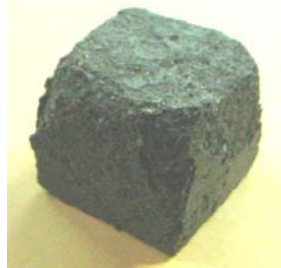
Figura 43. Desgaste mortero normal
