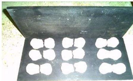
Figura 29. Falla de las probetas de tracción
