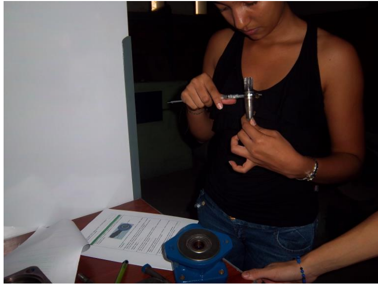
Figura 41. Medición de las piezas que conforman la bomba de paletas
