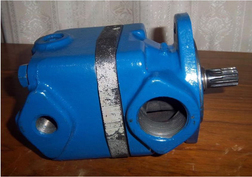
Figura 30. Conjunto mecánico bomba de paletas
