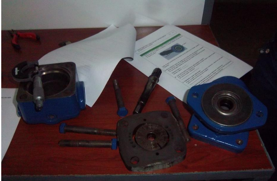
Figura 39. Desarme de la bomba de paletas
