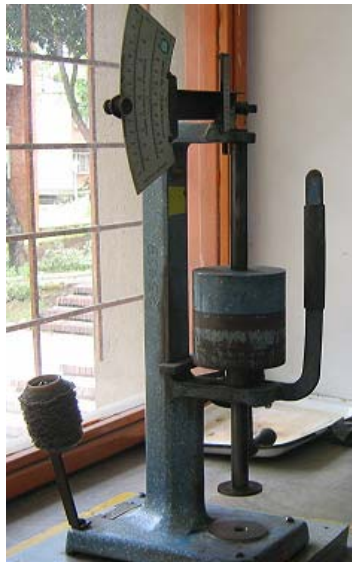
Figura 8 Compactador AFS. Dietert-Detroyt Laboratorio de arenas. Planta de aceros Alvaro Quiroga. UIS.
