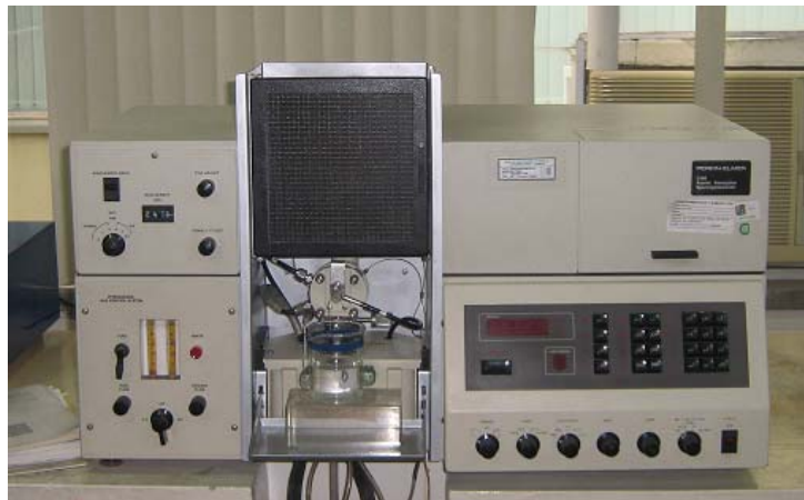
Figura 14. Espectrofotómetro de absorción atómica Perkin Elmer 2380. Laboratorio de Biohidrometalurgia. Grupo de Investigación en minerales, biohidrometalurgia y ambiente. Sede UIS – Guatiguará.
