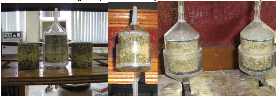
Figura 11 Estuche para el filtro. Elaborado en acrílico transparente, sellado y con dos conectores de manguera para la entrada y salida de la solución de trabajo.
