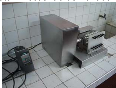
Figura 12 Bomba peristáltica. Laboratorio de Hidrometalurgia. Planta de aceros Alvaro Quiroga Correa. UIS. Caudal promedio 980 ml/min, 160 RPM en el rotor, 1600 RPM en el motor. Frecuencia del variador: 60 Hz.
