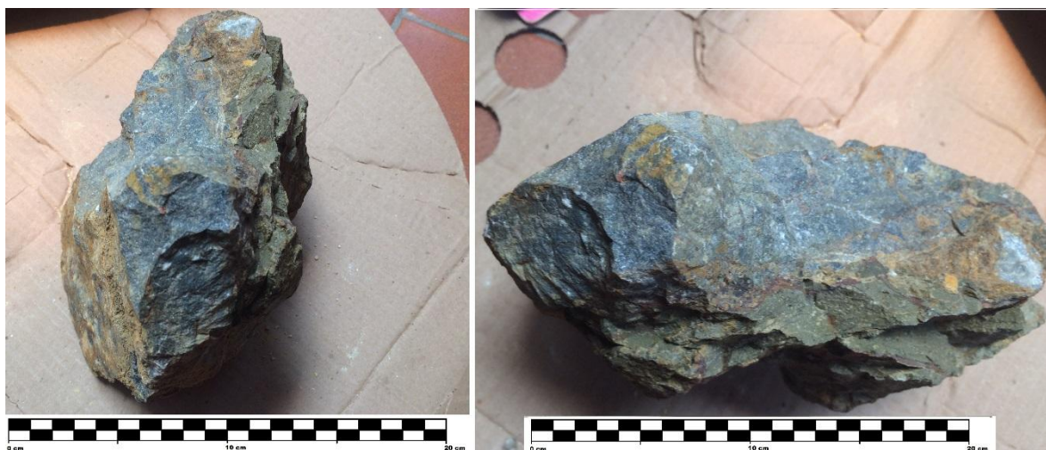
Figura 17. Caliza micrita, color gris oscuro. Muestra tomada en la cantera de Cementos Diamante de Cemex.
