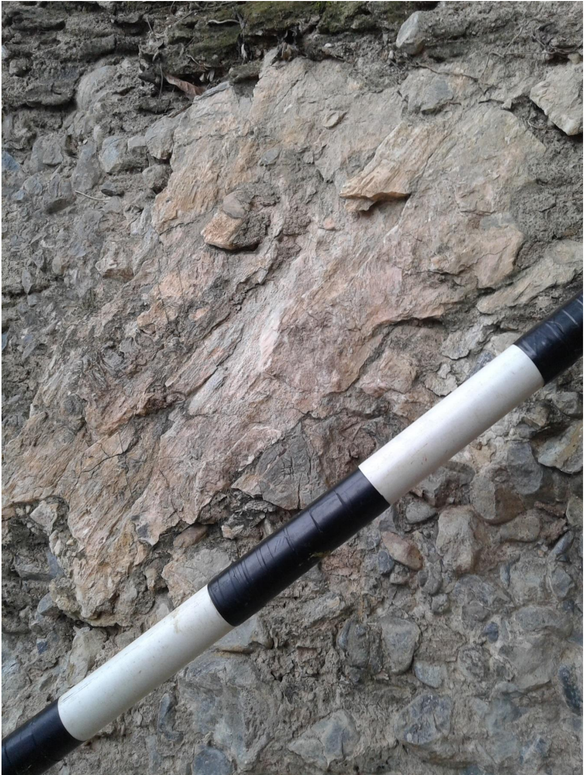
Figura 39. Plano estriado en calcirudita de la Formación Tiburón. Vía la Cantera – Río Suratá.
