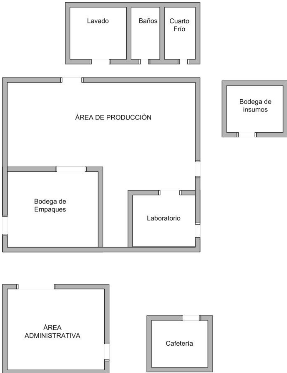
Figura C 13. Distribución de la planta
