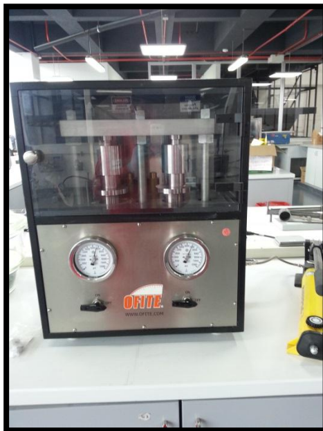
Figura 22. Celda de compactación de arcillas
