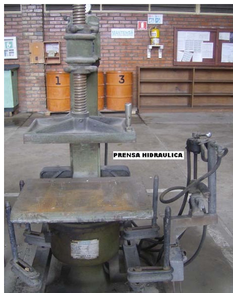
Figura 7. Prensa Hidráulica para el conformado de las probetas
