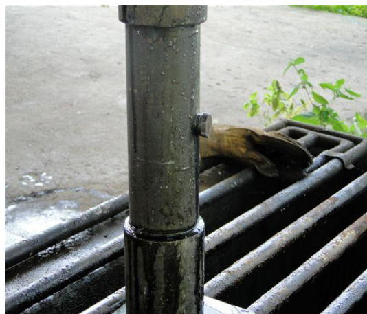
Figura 18, Válvula despresurizadora armada conectada al BHA
