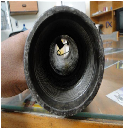
Figura 15. Válvula despresurizadora con pin de seguridad
