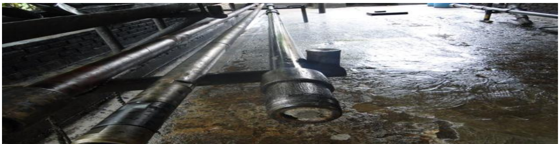
Figura 9 Bomba desarenadora taponada de arena después de realizar el trabajo el La Bonanza 32 foto taller bombas
