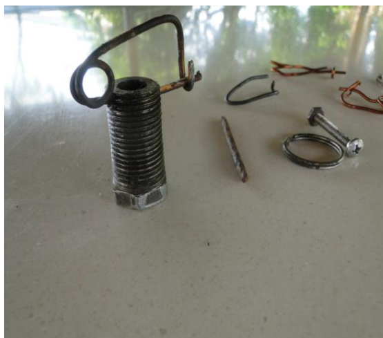
Figura 16. Vástago de la válvula con Chaveta o seguro.
