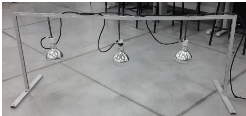
Figura 8. Estructura construida para variar temperatura
