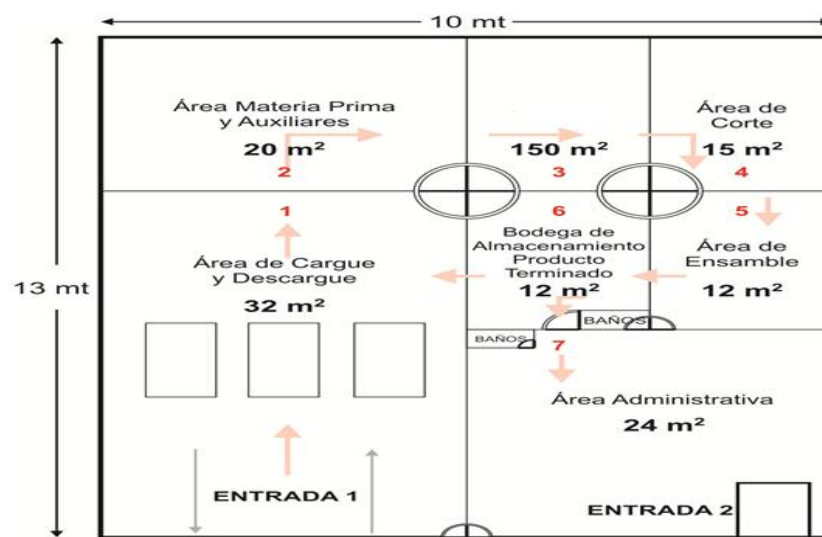
Ilustración 32. Distribución planta física
